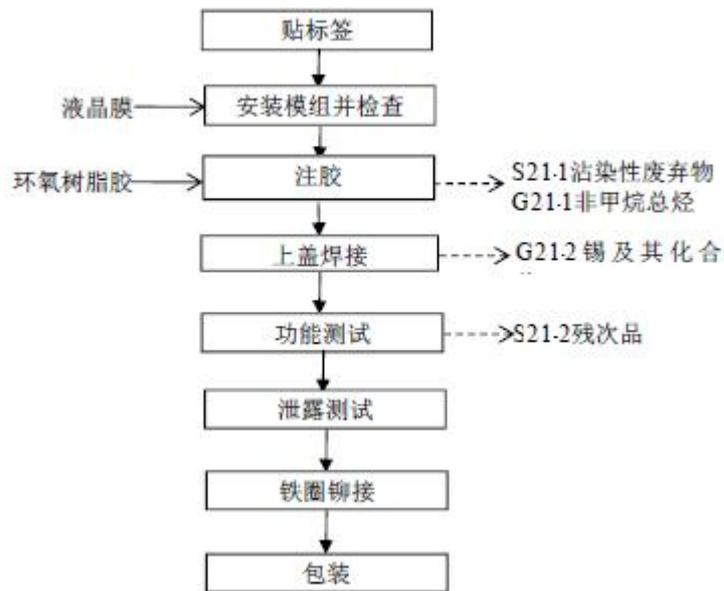
**图 2-27 小时表 (LCD) 开关工艺流程图及产污环节**
