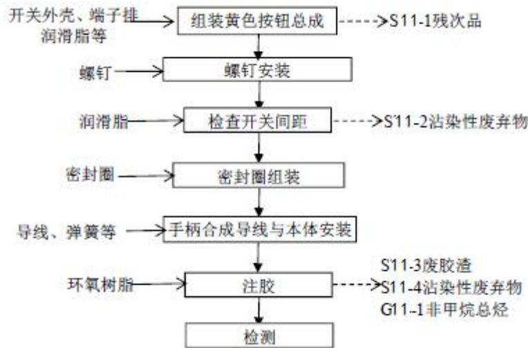
图 2-17 控制手柄类-TPYE-Q 工艺流程及产污环节
